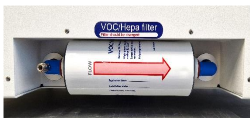
12.3 pav. Tinkamai įdėtas LOJ ir HEPA filtras
