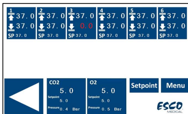
14.4 pav. Temperatūros jutiklio gedimo rodinys MIRI® TL6 daugiakamerio IVF inkubatoriaus pagrindiniame ekrane
