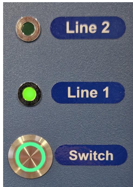
20.2 pav. MIRI® TL12 daugiakamerio IVF inkubatoriaus linija, keičianti jungiklį ir aktyvią 1-ą liniją
