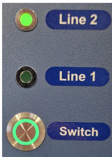
20.4 pav. MIRI® TL12 daugiakamerio IVF inkubatoriaus linija, keičianti jungiklį ir aktyvią 1-ą liniją
