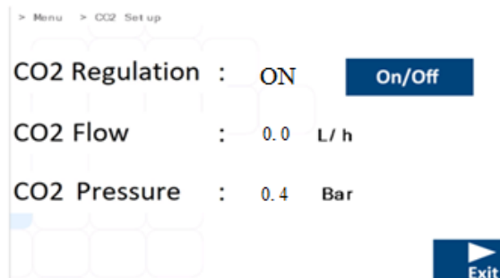
13.25 pav. MIRI® TL6 ir MIRI® TL12 daugiakamerio IVF inkubatoriaus CO 2 nustatymo antrinio meniu rodinys
