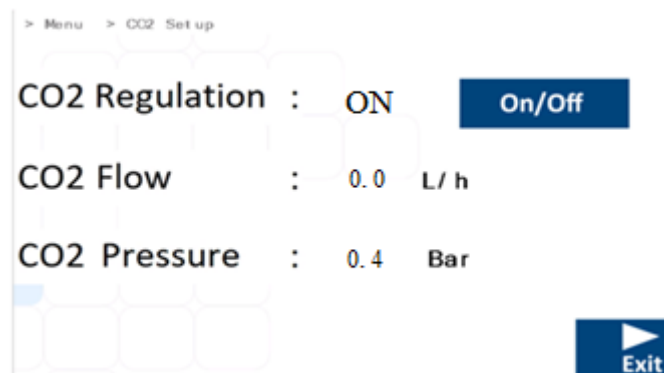
16.2 pav. MIRI® TL6 ir MIRI® TL12 daugiakamerio IVF inkubatoriaus CO 2 nustatymo antrinio meniu rodinys
