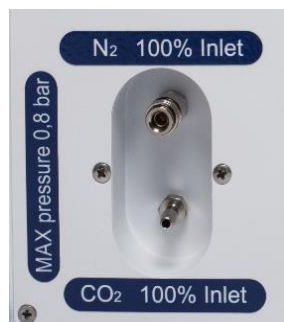
11.1 pav. Dujų tiekimo angos
