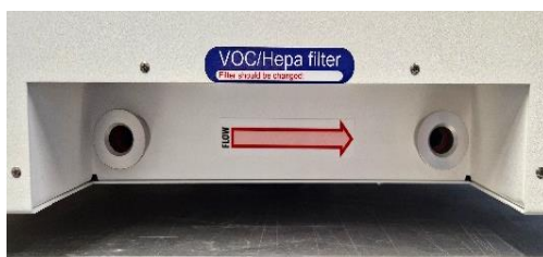
12.1 pav. Srauto rodyklė ant MIRI® TL6 ir MIRI® TL12 daugiakamerių IVF inkubatorių
